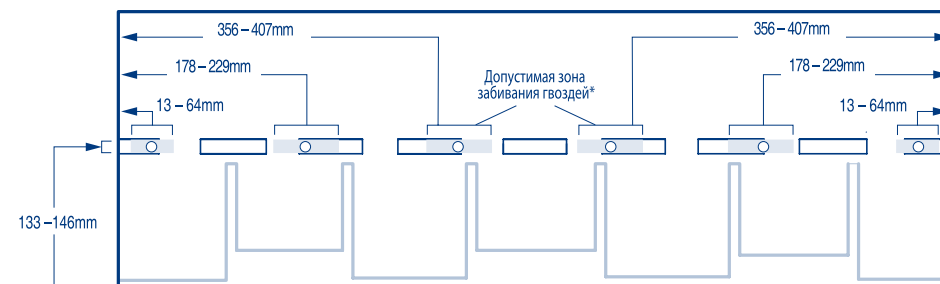
Схема крепления шестью гвоздями
