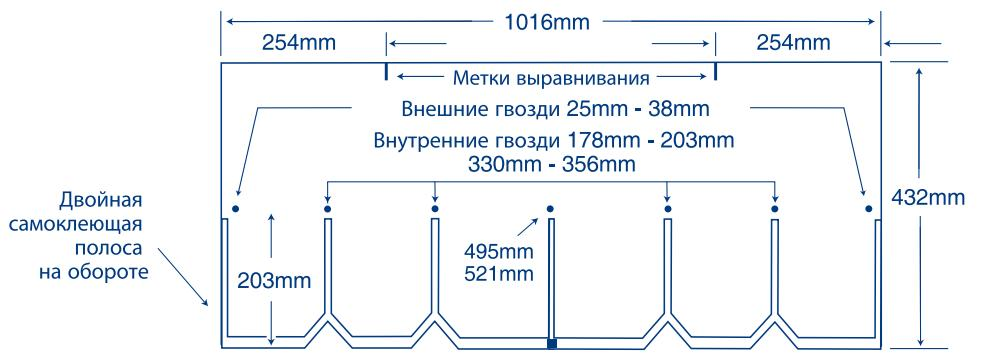
Схема крепления семью гвоздями, где по нормам следует забивать 6 или больше гвоздей
