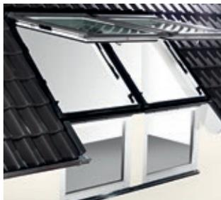
Вместе с системой окладов, создают функциональные фасадные соединения с мансардными окнами. Доступны в откидной версии (стандарт) и с двумя осями поворота створки. Безопасную эксплуатацию окна обеспечивает стеклопакет с безопасным стеклом – триплекс, а также ручка с замком под ключ (версия - с двумя осями поворота створки).
