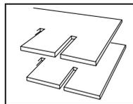
Оклад для плоских кровельных покрытий: битумный гонт. Боковые части из отдельных деталей.
