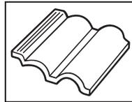
Оклад для профилированных покрытий, с высотой волны до 45 мм (металлочерепица, профнастил, керамическая черепица).
